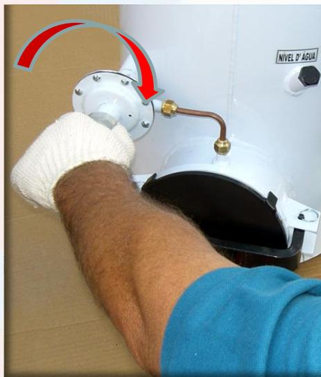
Para iniciar o carregamento de gás, gire suavemente a monopla da válvula diafragma para a direita. Isso fará com que a água goteje sobre as pedras de carbureto gerando o gás acetileno.
