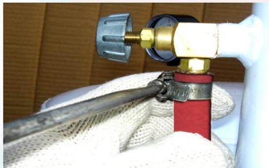
Como o Gerador Metalbom trabalha com baixa pressão, a mangueira é conectada entre a torneira de saída e a caneta de solda sem passar pelo regulador de pressão.
