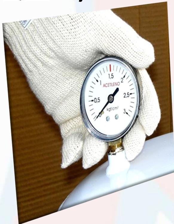
Verifique se não há gás dentro do cilindro. O Manômetro deve estar indicando Zero de pressão
