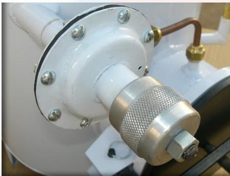
A válvula diafragma é responsável por regular a pressão de trabalho do gerador Metalbom. Uma vez em funcionamento, ela mantém a pressão do sistema automaticamente.
