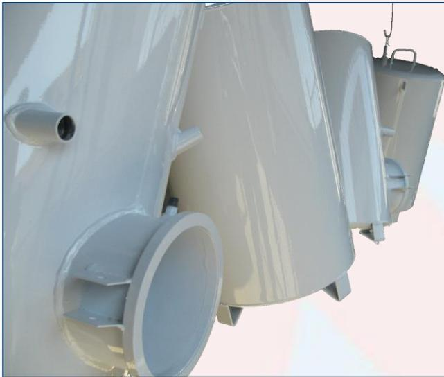
Sistema de pintura eletrostática dá um acabamento perfeito além de aumentar a resistência ao desgaste e oxidação
